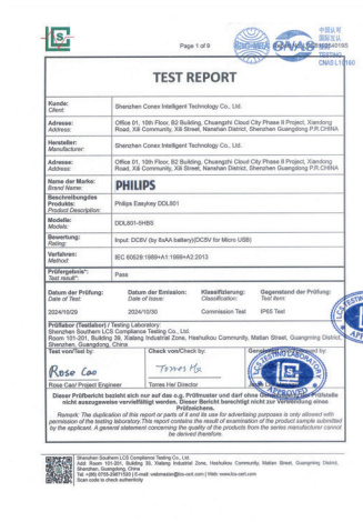
Báo cáo chống nước, chống bụi của khóa Philips DDL801-5HBS
